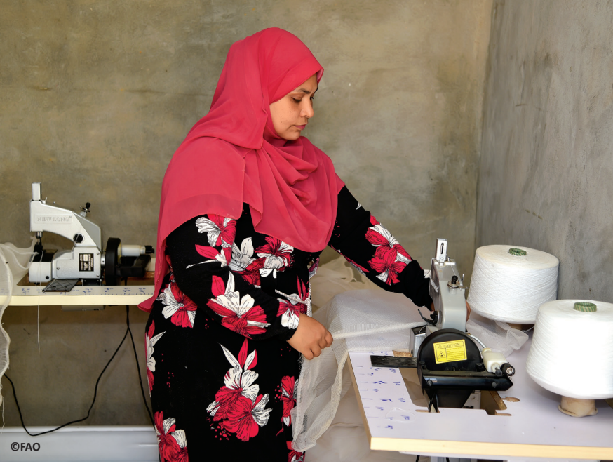
ماكينة لتصنيع شباك لحماية ثمار البلح كنشاط إضافي للشركة.
