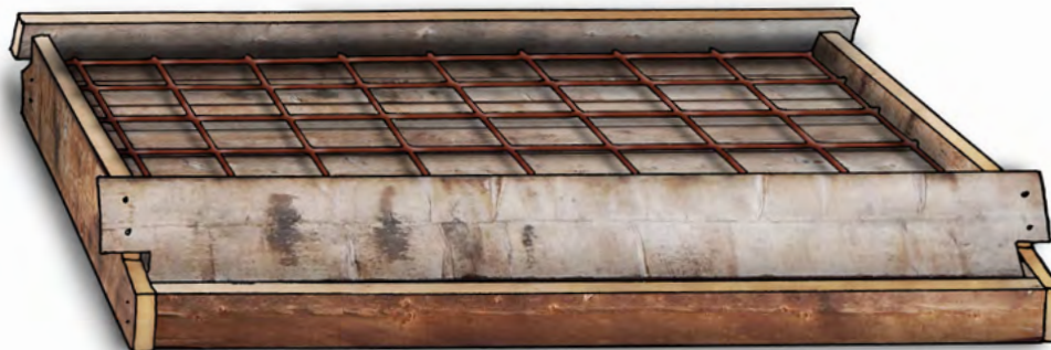
Figura 11. Molde con armazón preparado para el colado (casita de dos bocas).
