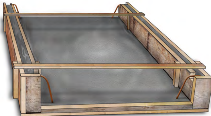
Figura 16. Colado de la casita ligera.
