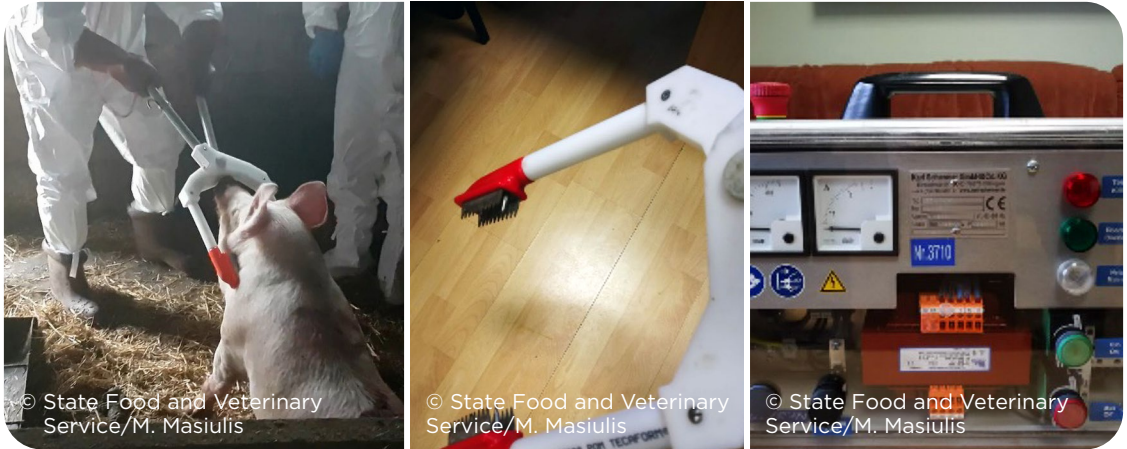
Hình 3. Giết bằng điện: kẹp kiểu cắt kéo và truyền dòng điện vào đầu lợn ở vị trí chạy xuyên qua qua não.
