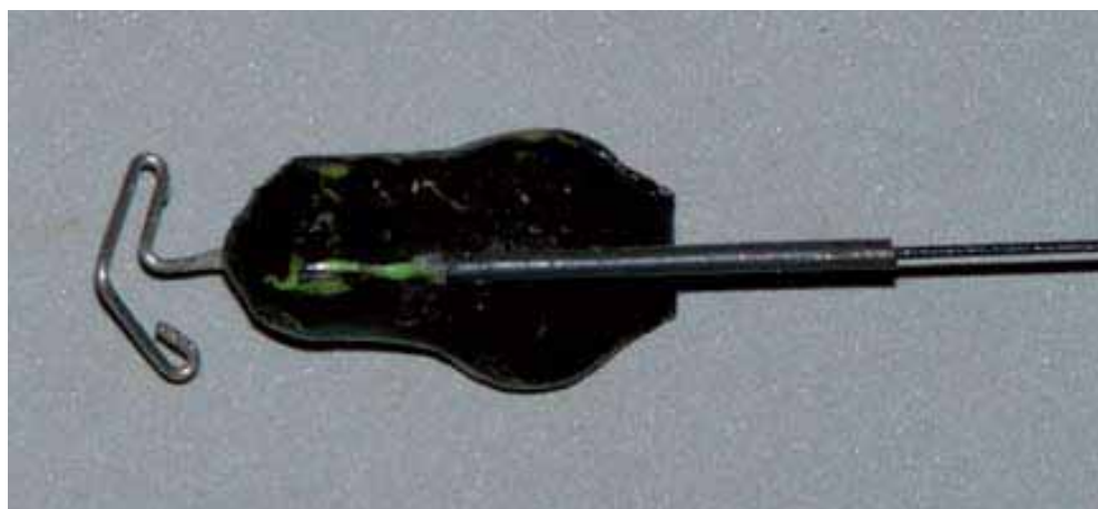
FIGURE 7.1 Émetteur radio VHF implanté
