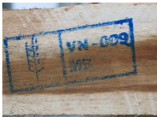
La marque, apposée à l'aide d'un tampon encreur, correspond à l'exemple 1 de l'annexe 2 de la norme NIMP 15.
