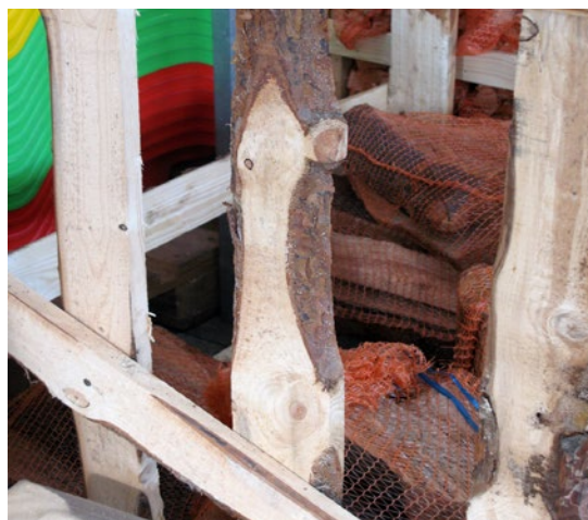
L'écorce dépasse les tolérances: cette caisse en bois n'est pas conforme à la norme NIMP 15.
