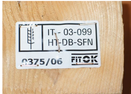
Marque transférable (la marque ne doit pas être transférable; les étiquettes ne sont pas conformes à la norme NIMP 15).
