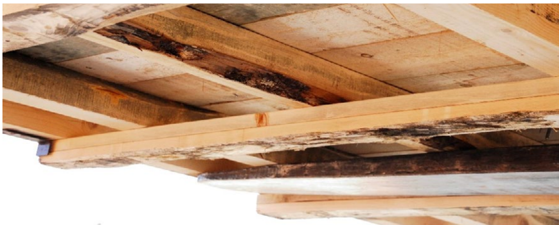
L'écorce dépasse les tolérances: cette unité de matériau d'emballage en bois n'est pas conforme à la norme NIMP 15.
