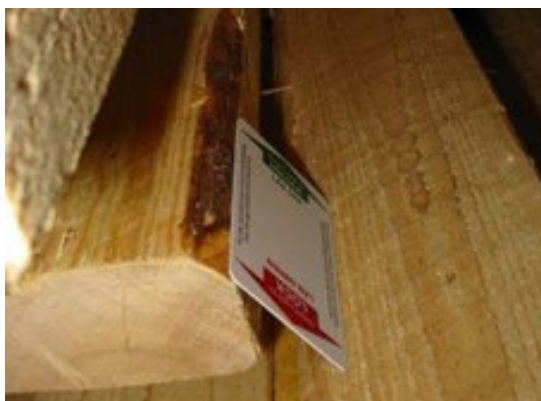
L'écorce sur le bord du bois est plus large que 3 cm et la pièce est plus grande que 50 cm 2 : l'écorce doit être enlevée, ou la pièce ne peut pas être utilisée comme bois de calage ou pour construire des matériaux d'emballage en bois.
