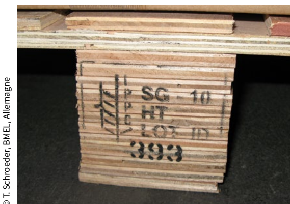
La ligne verticale à droite du symbole est manquante, des informations supplémentaires sont incluses dans la marque, et la marque est apposée au bois transformé.
