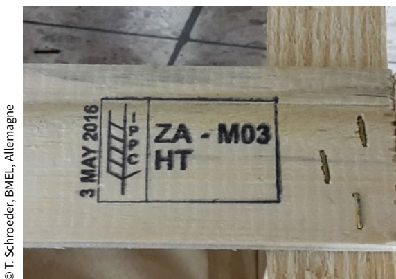
La marque, apposée à l'aide d'un tampon encreur, correspond à l'exemple 1 de l'annexe 2 de la norme NIMP 15 et comporte des informations supplémentaires à côté de la marque.
