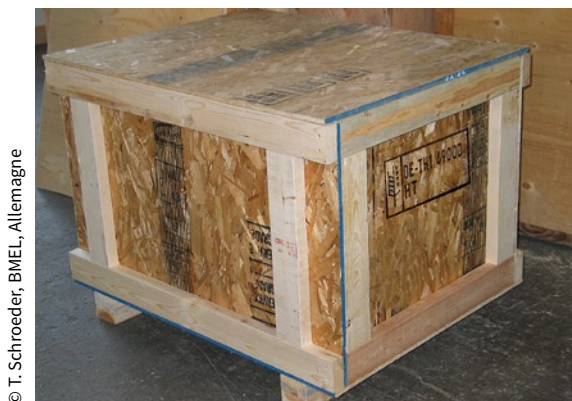
Exemple d'une marque NIMP 15 apposée sur le composant OSB d'une unité de matériaux d'emballage en bois pour une meilleure visibilité. La marque doit être interprétée par les ONPV comme une confirmation que l'unité entière est certifiée NIMP 15.
