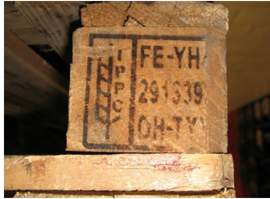
Marque frauduleuse avec des codes non valables (pas de pays avec le code "FE" et pas de traitement avec le code "OH").
