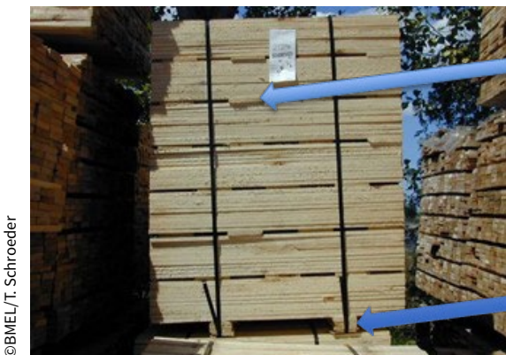
Le bois de calage intégré dans les paquets de bois, comme les entretoises ou les blocs indiqués par des flèches sur cette photographie, n'est pas un matériau d'emballage en bois et n'a pas besoin d'être marqué individuellement.
