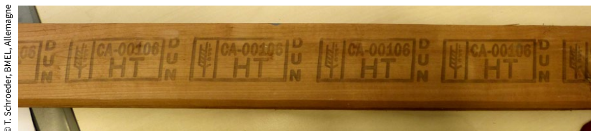
La marque correspondant à l'exemple 1 de l'annexe 2 de la NIMP 15 comporte des informations supplémentaires à côté de la marque pour indiquer que le matériau est certifié pour être utilisé comme bois de calage.
