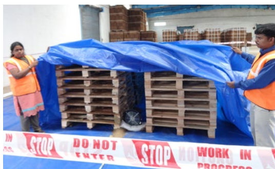
Préparation de la fumigation de palettes en bois sous des feuilles ou des couvertures étanches au gaz.
