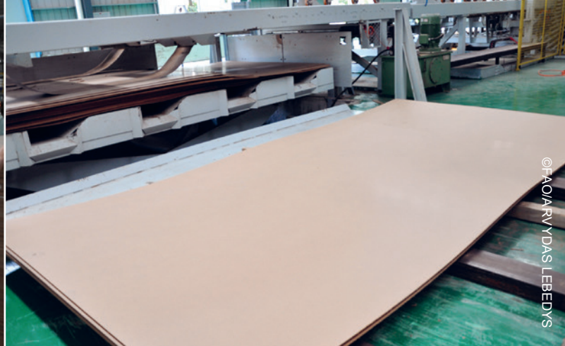
FIGURE 10B. Production de panneaux de fibres
