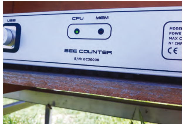
图 19-2 蜂箱入口处蜜蜂计数器示例
