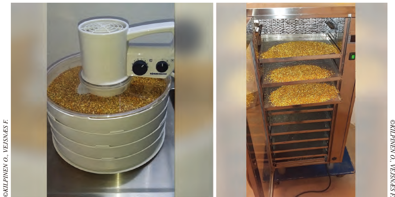
图9-12 不同类型的花粉干燥机示例
