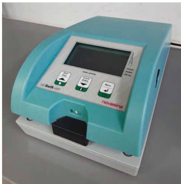
图 9-15 Novasina LabSwift-AW——水分活度仪示例
