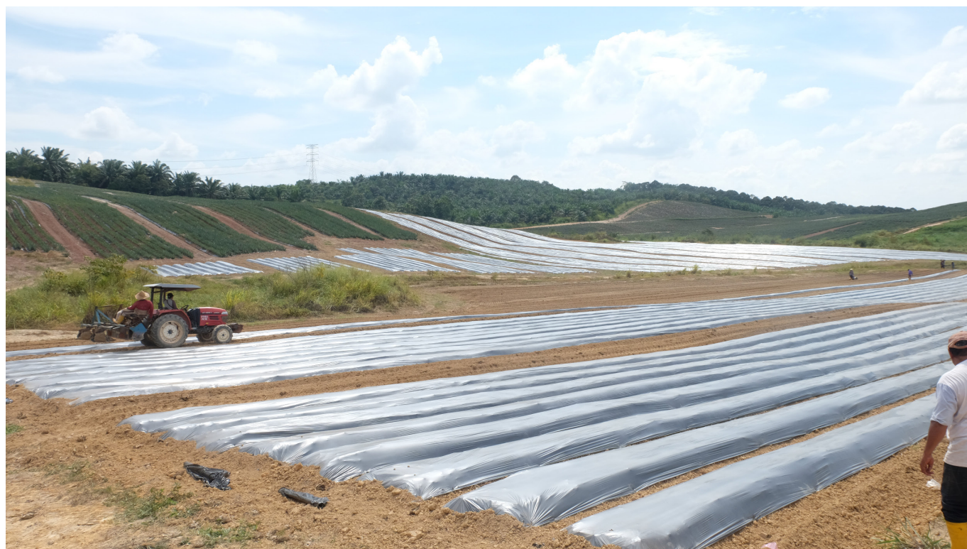
Figura 18. Tractor con equipo modificado utilizado para colocar mantillo de plástico metálico plateado para el cultivo de piña en Malasia
