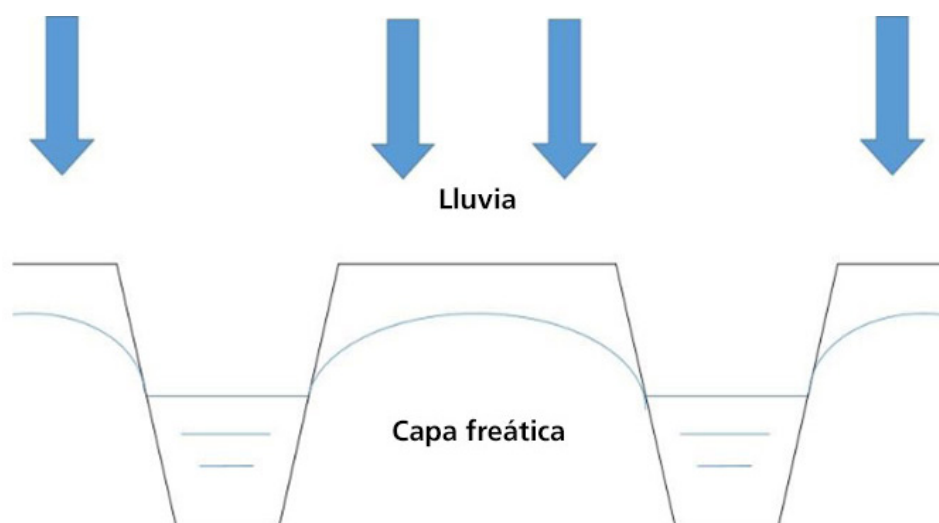
Figura 9. Sistema de drenaje superficial por zanjas abiertas
