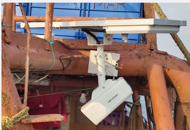
Камера с солнечной батареей на борту рыболовного судна в Красном море © ФАО / Педро Гемес
